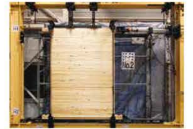
床構造体の水平耐力試験
