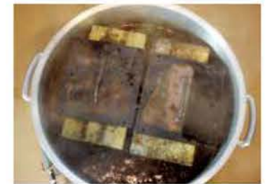
接着重ね梁の接着性能試験
