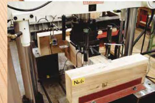
接合部の強度性能試験
