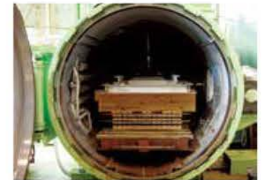
木材の熱処理試験
